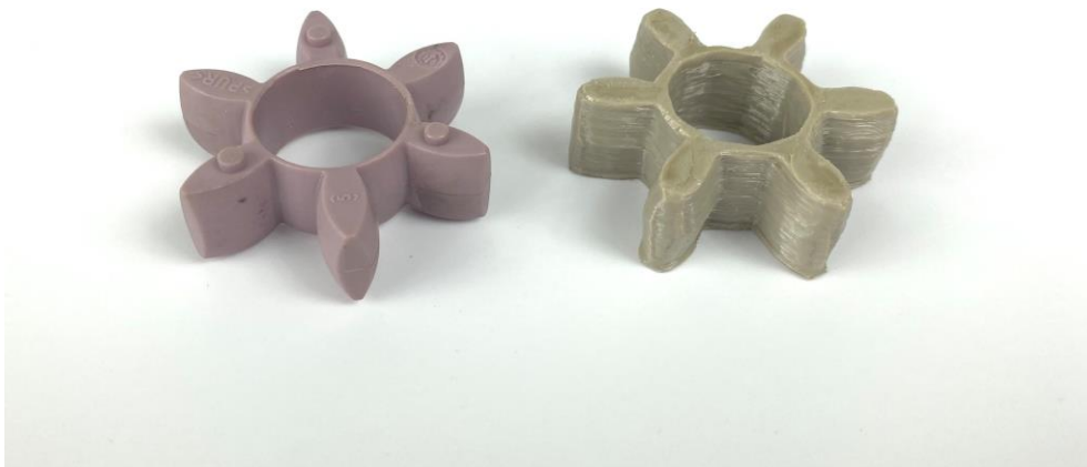
Abb. 1: Zahnrad aus PUR und 3D-gedrucktes Zahnrad aus LUVOCOM 3F PEEK 9581 NT
