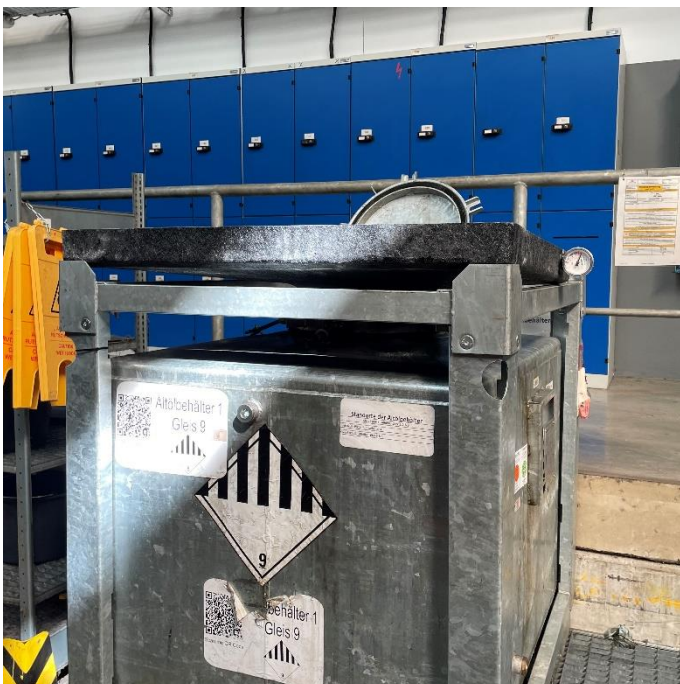
Einsatz des gedruckten Trichters auf einem Altölbehälter
